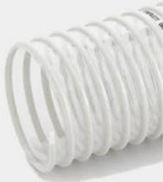
Стенка толщиной 1,2 мм из термопластичного полиуретана армирована стальной омедненной спиралью. Предназначен для аспирации, транспортировки крупных и тяжелых абразивных материалов в деревообрабатывающей, химической промышленности и сельском хозяйстве.
